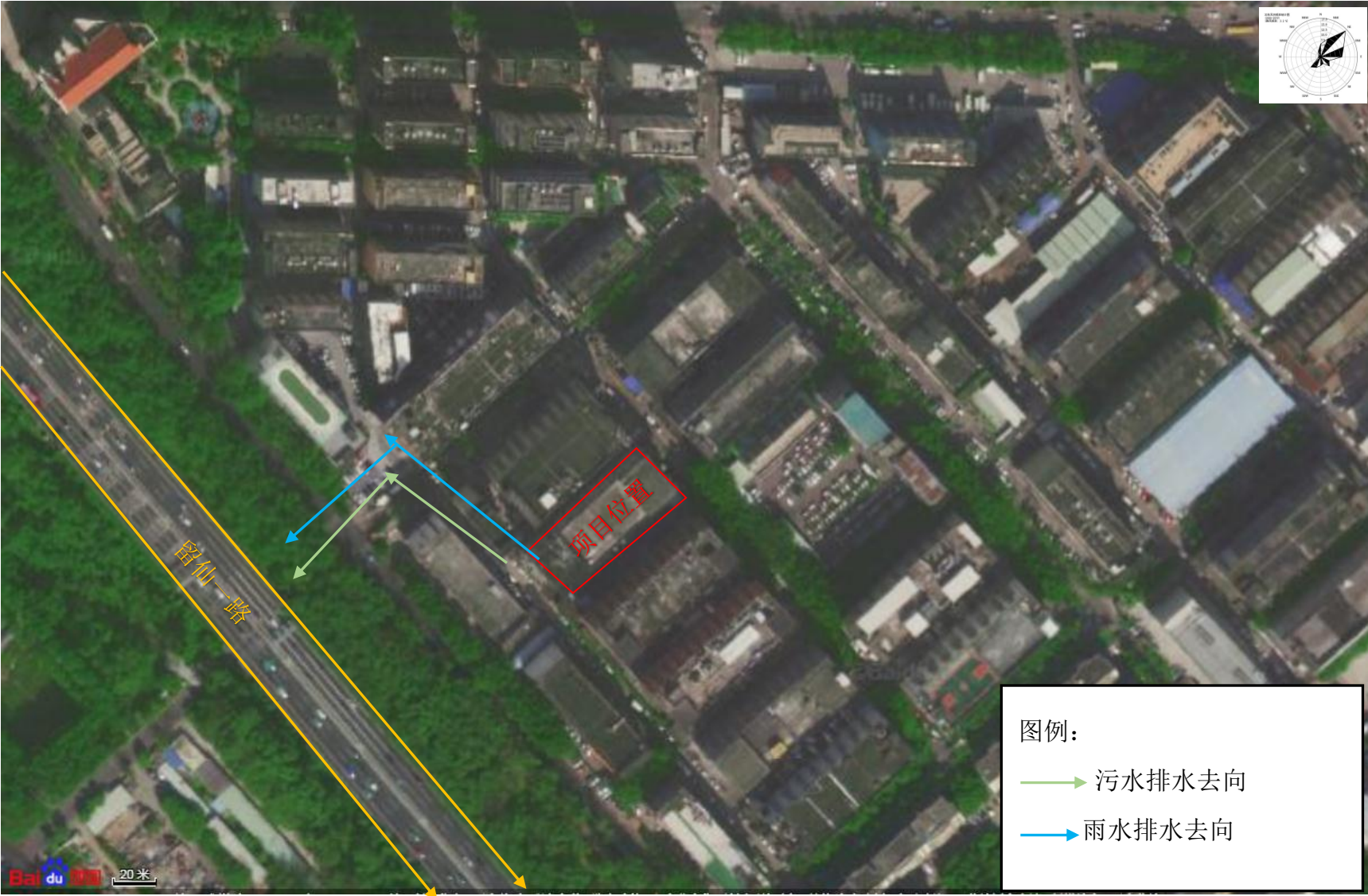
附图 14 项目排水管线平面布置及排水路径示意图
